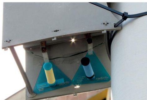
Figure 3 : Dispositif de prélèvement par tubes passifs
