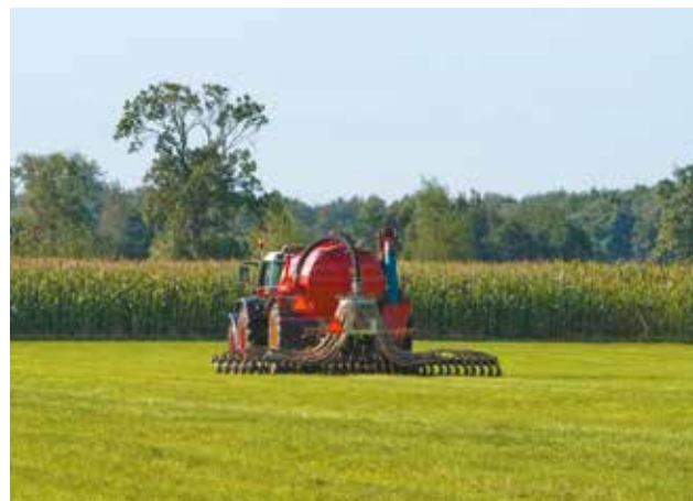
L'épandage du digestat par pendillard permet de limiter les émissions d'ammoniac car le fertilisant n'est plus projeté dans l'air et est mieux absorbé par le sol.
