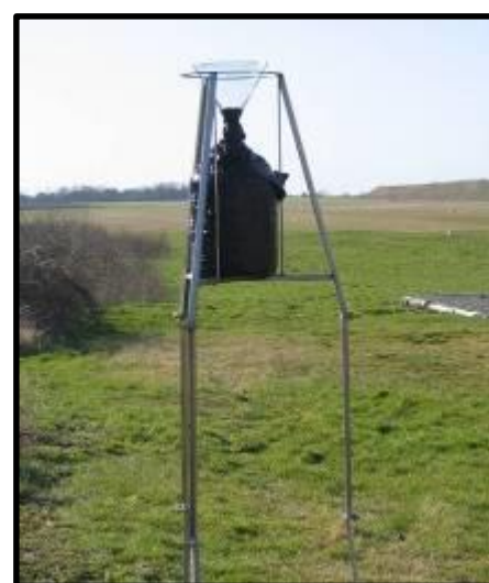
Figure 2 : Prélèveur passif de type Jauge Owen sur trépied
