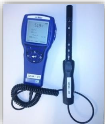
Figure 7 : Q-Trak, instrument de mesure des oxydes de carbone
