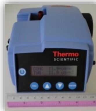
Figure 1 : pDR1500, instrument de mesure des particules en suspension
