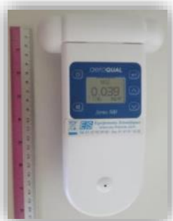
Figure 2 : Analyseur portatif série 500 d'Aéroqual pour la mesure du NO 2
