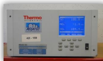
Figure 3 : Analyseur de référence (421) pour la mesure du NO 2
