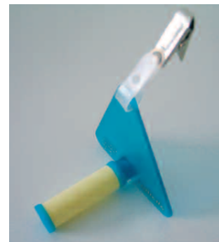
Tube passif benzène sur son support
