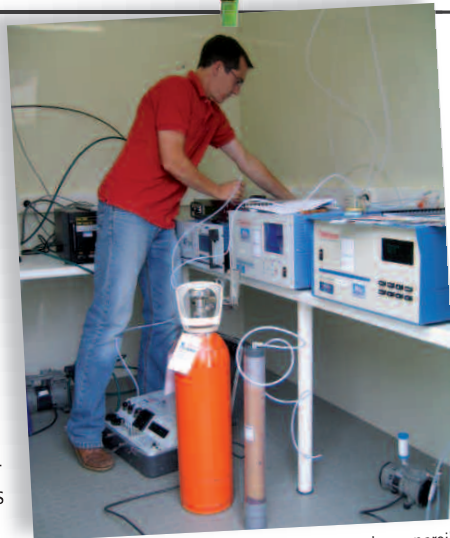
Etalonnage des appareils de mesures sur site
