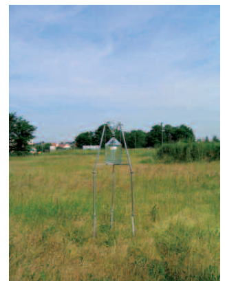
Préleveurs passifs type Jauge Owen sur trépied.
